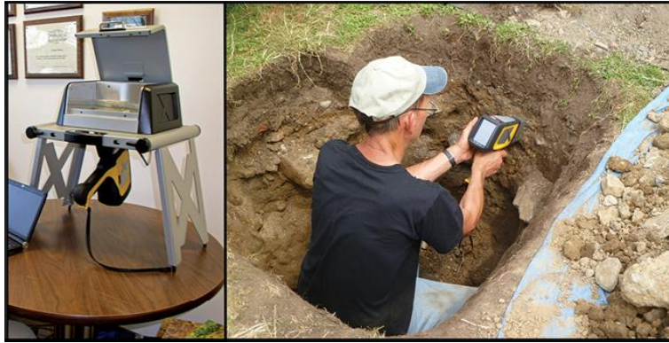
شكل 6-15: جهاز طيف XRF محمول، يمكن وصله بمنصة مراقبة في المكتب لمسح العينات التي تم جمعها (على اليسار) أو استخدامه في الحقل لمسح الأوجه المكشوفة لحفر التربة أو الأسطح (على اليمين).
