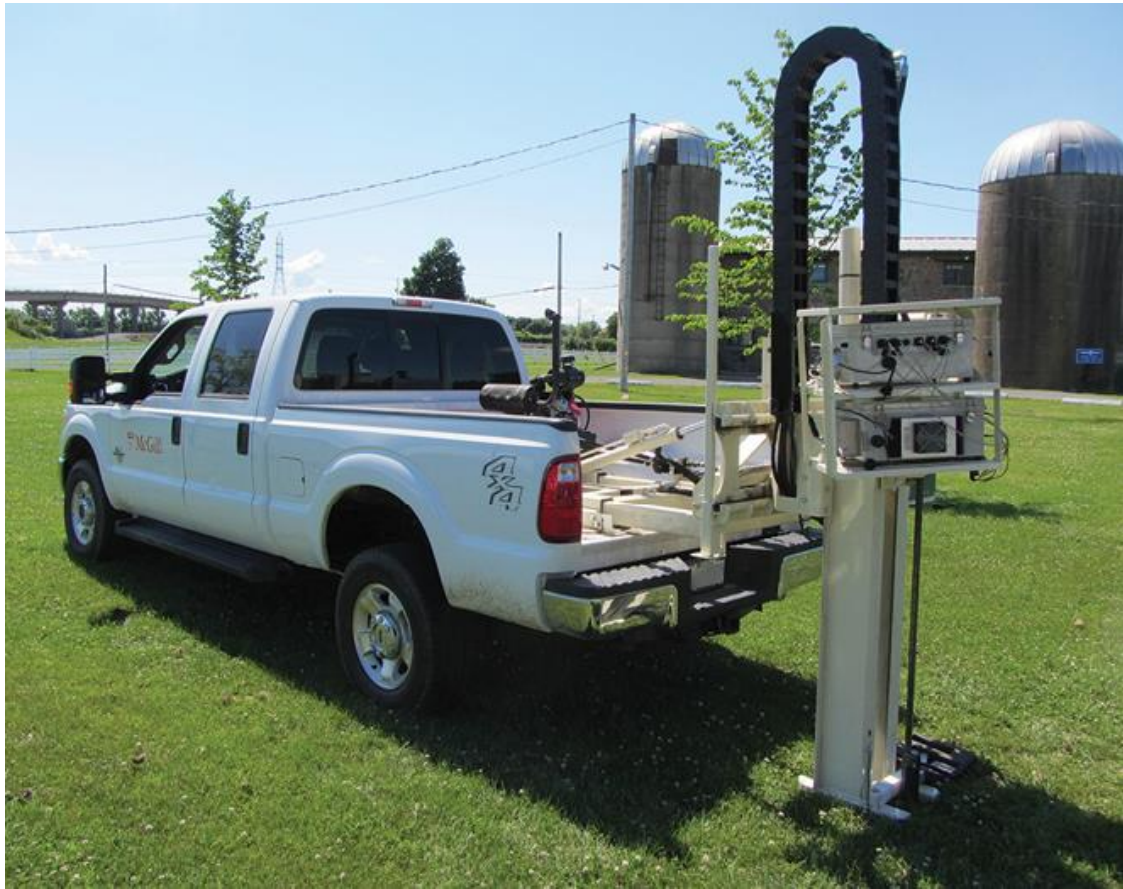
شكل 6-16: مجس مزود بأجهزة استشعار ومقاييس طيف، تغطي الأجزاء المرئية من الطيف والأشعة تحت الحمراء القريبة بالإضافة إلى التوصيل الكهربائي.
