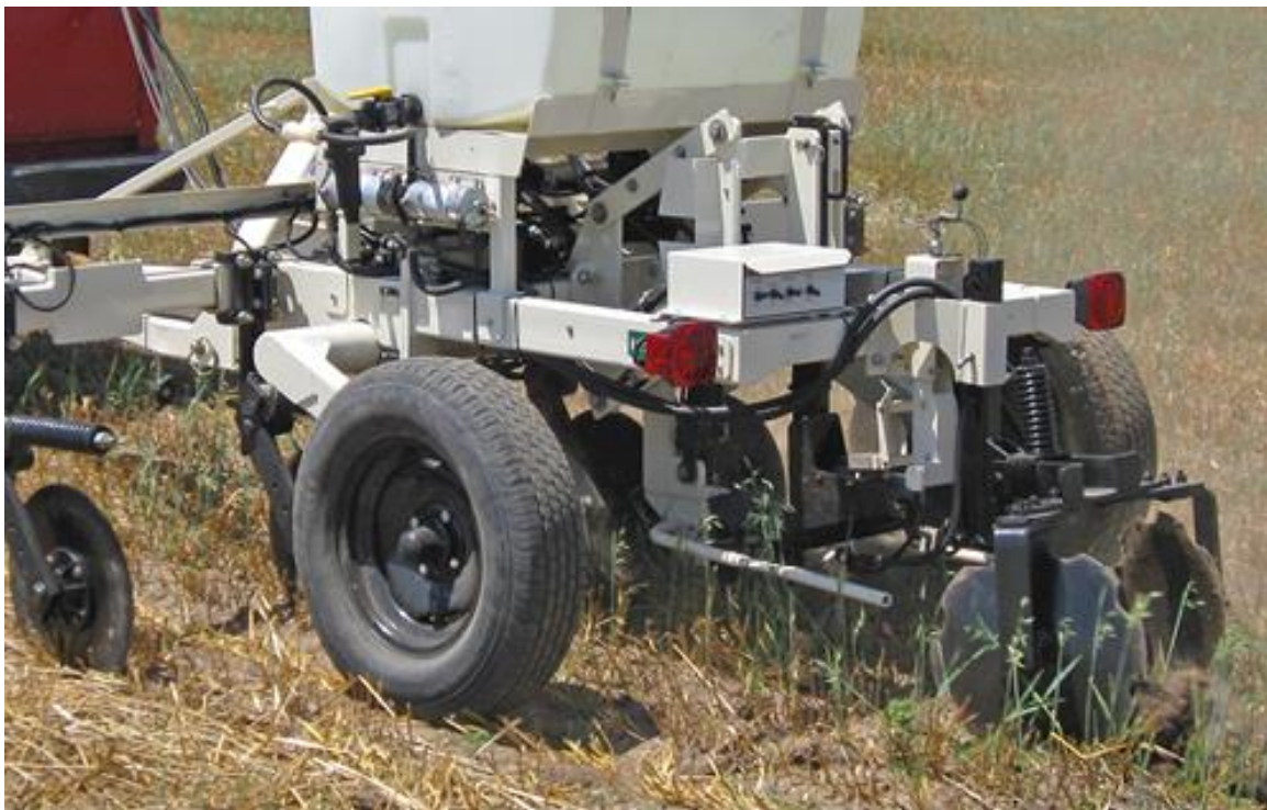
شكل 6-18: آلية أخذ العينات لنظام قطر يرسم فى نفس الوقت خريطة pH والتوصيل الكهربائى الظاهرى للتربة.
