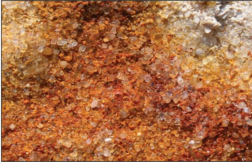
شكل 3-21: حبيبات رمل (تظهر على شكل حبيبات كوارتز مفردة) مغلقة ومربوطة بالطين.
