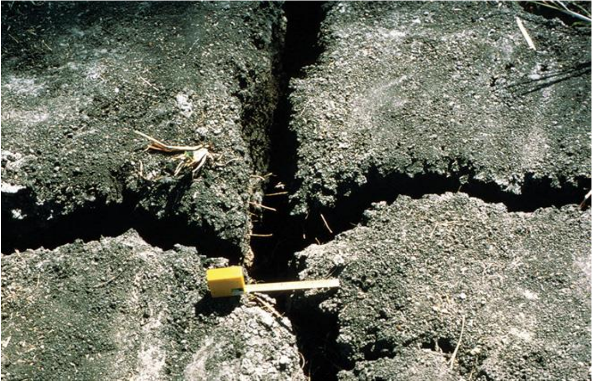
شكل 3-19: شقوق عكسية كبيرة عبر الأفق تمتد من السطح إلى تحت التربة الطينية (Vertisol).
