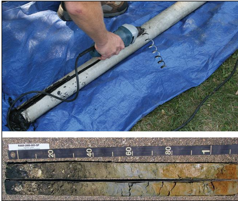
شكل 10-4: قلب أخذ عينات تحت الماء. الصورة العلوية - قطع لفتح القلب بمقص كهربائي. الصورة السفلية - قلب منقسم يظهر التربة. عادة تؤخذ عينات من جانب، والآخر يتم تخزينه وأرشفته.
