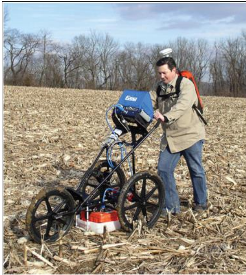
شكل 1-6: أنظمة GPR حديثة خفيفة وقابلة للحركة ومتكاملة. يتكون نظام GPR النموذجى من وحدة تحكم (أسفل الحجاب الأزرق على العربة) بهوائى (صندوق برتقالى أسفل العربة).
