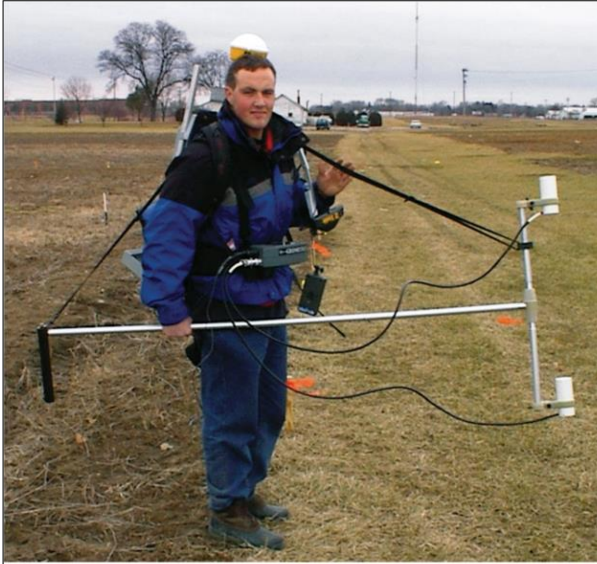
شكل 6-14: الحصر المغناطيسي باستخدام مقياس تدرج بخار السيزيوم (Geometrics, 2016) مدمج مع مستقبل نظام تحديد المواقع العالمي (Trimble, 2016).
