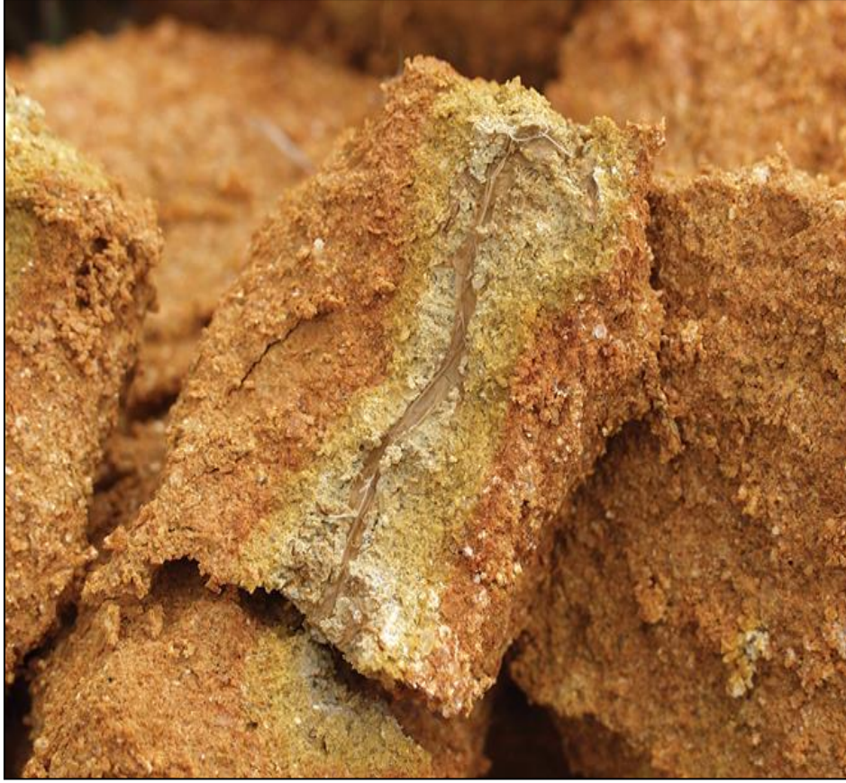
شكل 3-27: مظاهر أكسدة واختزال تتكون من تركيز أكسدة واختزال، كتلة حديد (منطقة حمراء على طول سطح وحدة البناء) ونضوب الحديد (منطقة لونها فاتح تحيط بقناة الجذر في داخل وحدة البناء). (Photo courtesy of John Kelley)
