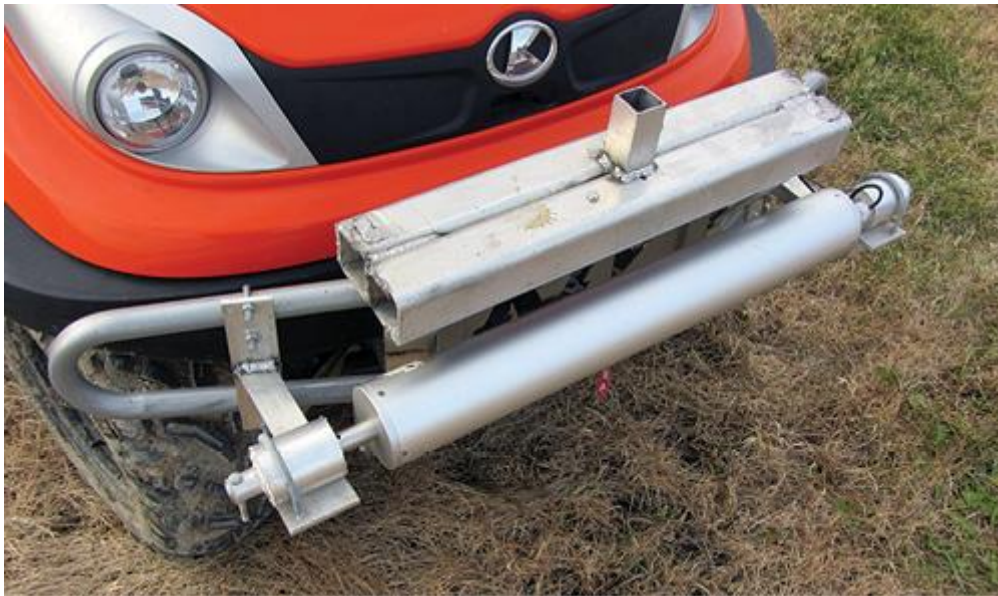
شكل 6-17: جهاز استشعار أشعة جاما سلبية مركب على سيارة.
