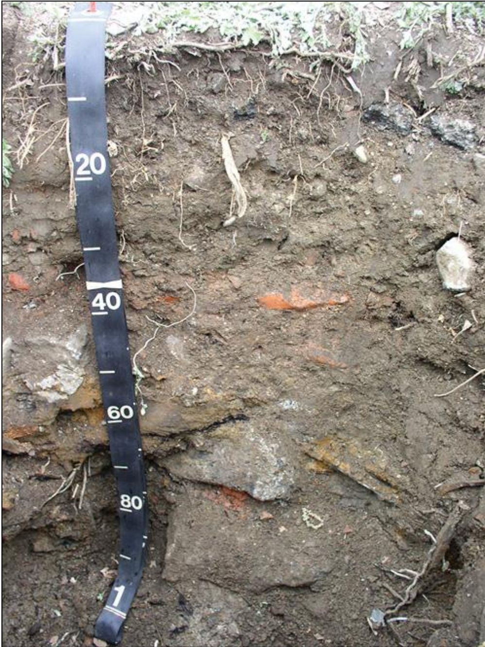
شكل 11-3: قطاع سلسلة تربة لاجوارديا (Laguardia) يظهر قطع أثرية في ترسيبات متعددة من مواد منقولة بواسطة الإنسان. يحتوى حطام المبنى المدفون على طوب وخرسانة وأسلاك وصلب وأسفلت. (تصوير Richard Shaw)
