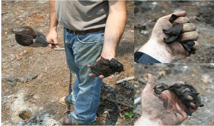
شكل 3-28: اختبار حقلي لطريقة الفشل على تربة متوسطة السيولة. (Photo courtesy of John Kelley).
